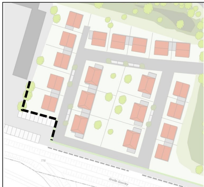
Abbildung 6: Lärmschutzwand (gestrichelte Linie)
